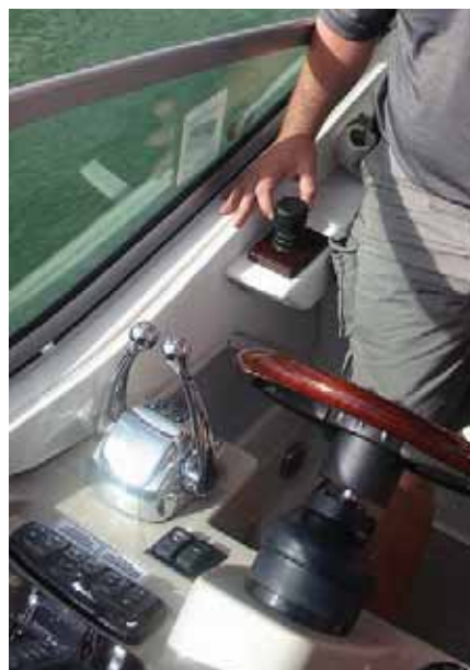
Система «Axis», предназначенная для стационаров «MerCruiser» – чувствительный джойстик
