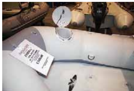
Конструкторы «Zodiac» придумали оснащать баллоны РИБов и надувнушек герметичными пластиковыми емкостями
