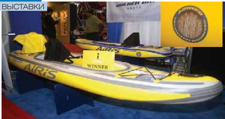
Каяк «Airis» от компании «Walker Bay». Материал на бортах и днище этой надувнушки состоит из семи полимерных слоев, соединенных изнутри тысячами плетеных волокон.
