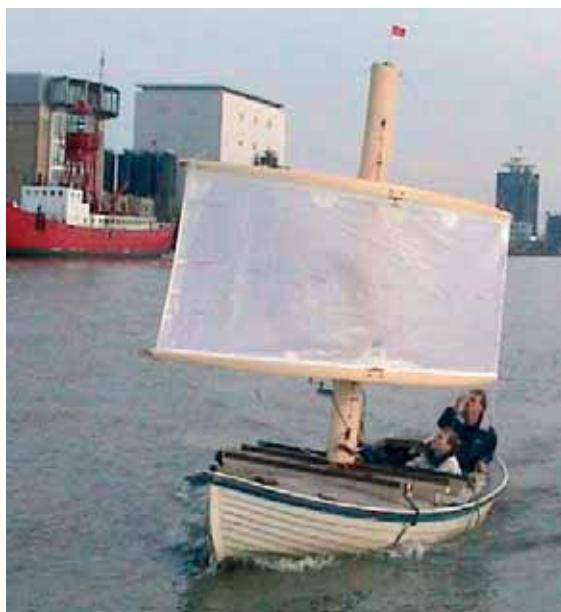
Так начинался «Falconrig»: слева – первый «ходовой макет» этого вооружения, установленный на обычной шлюпке, справа – радиоуправляемый макет яхты «Maltese Falcon» на фоне «практического макета» паруса в натуральную величину
