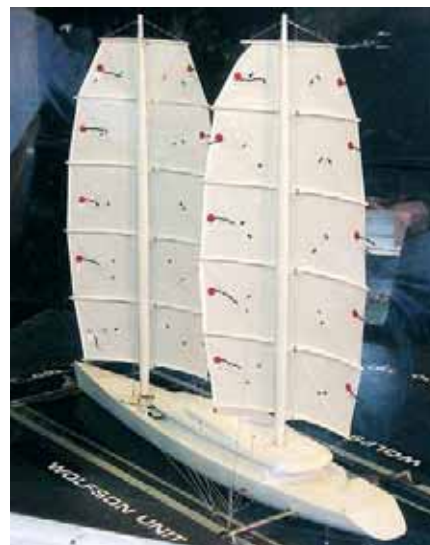
Продувка модели будущей 63-метровой яхты в аэродинамической трубе
