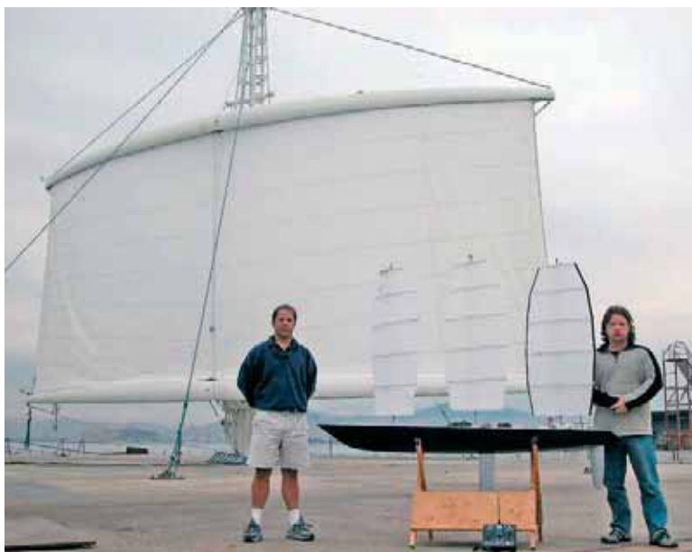
Так начинался «Falconrig»: слева – первый «ходовой макет» этого вооружения, установленный на обычной шлюпке, справа – радиоуправляемый макет яхты «Maltese Falcon» на фоне «практического макета» паруса в натуральную величину
