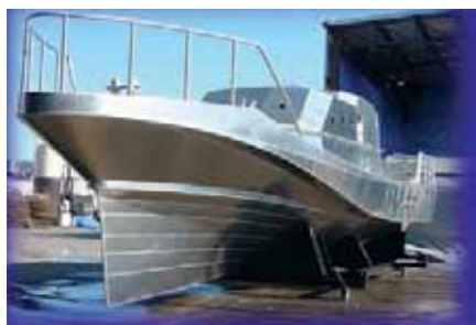
Рис. 4. Закрученное плоско-килеватое днище – 100 лет популярности («SDV-45», «Navatek Ltd»)
