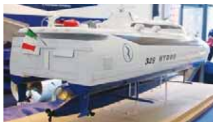
Рис. 9. Скоростной паром со вспомогательными подводными крыльями
