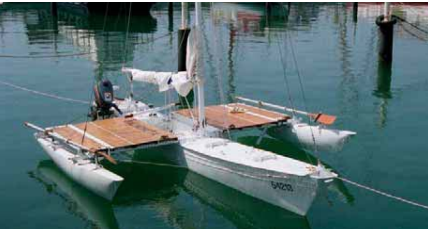
Лодка автора после переделок: запалублены секции центрального корпуса; жесткая палуба моста; ПМ перенесен с транца на бортовой кронштейн; длинный румпель заменен тросовой передачей от поперечины («качалки»); усилено крепление поперечных балок; мачта раскреплена такелажем
