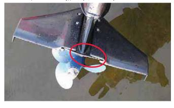
если не считать того, что не совсем удобно сверлить отверстия в антикавитационной плите «Нептуна 25», так как мешают элементы конструкции. Болты и самоконтрящиеся гайки входят в комплект.
