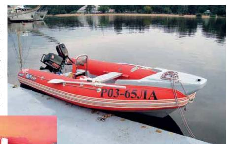
Условия проведения эксперимента: температура воздуха – 10–14° С, температура воды –11–12° С, ветер восточный 2–4 м/с, волнение – от полностью спокойной воды до 70 см, скорость течения – 2 м/с. Бензин Аи-80, масло «Yamalube 2S».
