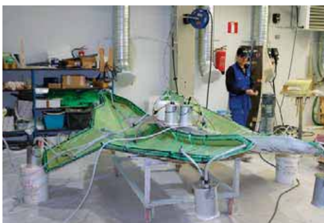
Корпуса лодок формируют на «Charger Composites» с применением вакуумной инфузии
