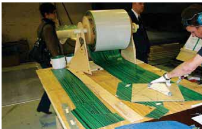
Сверхлегкие корпуса уникальных яхт от «Baltic Yachts» – результат применения самых современных технологий формовки из углетканевых препрегов
