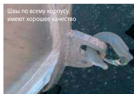
Оригинальный «килёк» является частью конструкции
