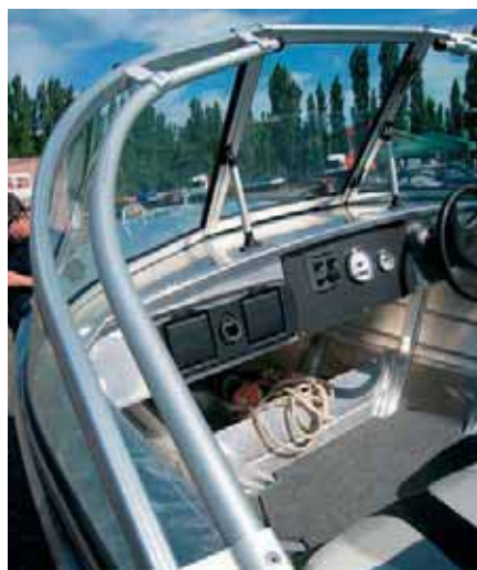
Удобное и красивое ветровое стекло с поручнями и открывающейся форточкой для выхода на нос.
