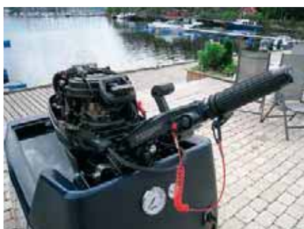
Наклонное фиксируемое положение румпеля – оригинальный ход «Evinrude»
