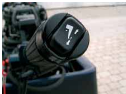
Клавиша управления тримом моторов «25/30 E-Тес» в торце рукоятки газа
