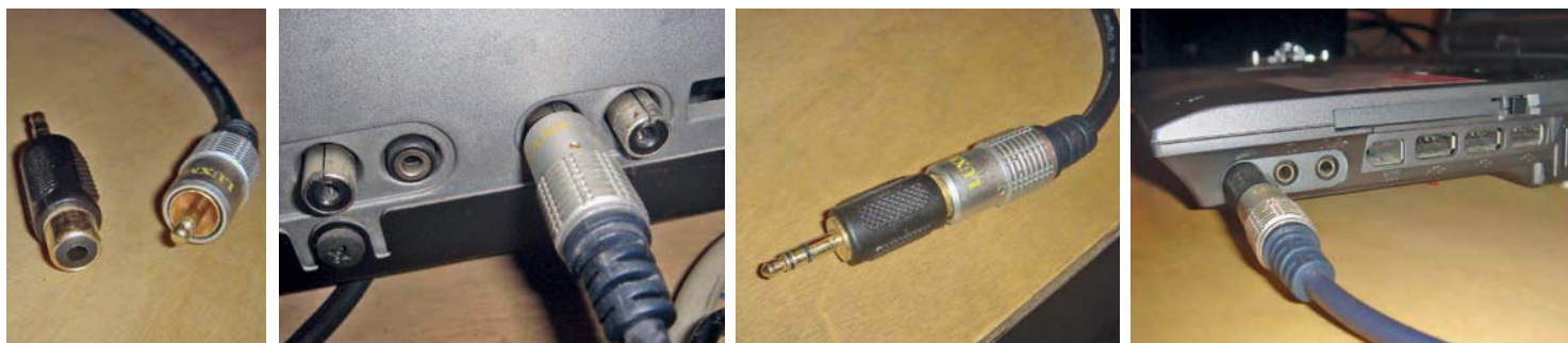
Рис.2. Варианты исполнения разъемов шнура для связи приемника с компьютером, слева – «тюльпанчики», справа – штекеры для монофонических наушников
