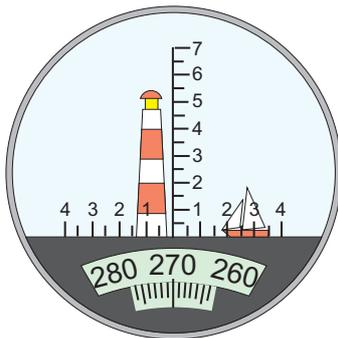
Рис. 6. Маленькие лодки постоянно качает, поэтому пользоваться настоящим компасом-пеленгатором не всегда удобно. Гораздо сподручнее хороший морской бинокль со встроенным компасом. Как правило, его конструкция предусматривает и дальнометрическую шкалу.
