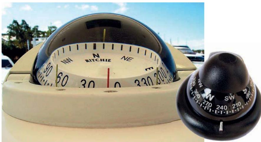
Рис. 5. На маломерных судах можно обойтись и без «кардана» – здесь чаще всего применяются полусферические картушки на остроконечной шпильке. «Плавают» они либо в корпусе в виде прозрачного шарика, либо прикрыты полукруглым «блистером».
