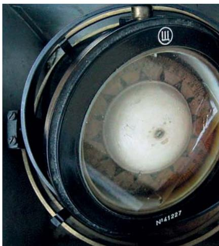
Рис. 4. «Карданов подвес» позволяет компасу чувствовать себя вольготно даже при сильной качке. Кстати, это нехитрое изобретение итальянского мастера-каретника также помогает яхтсменам не расплескать содержимое чайника на камбузе.
