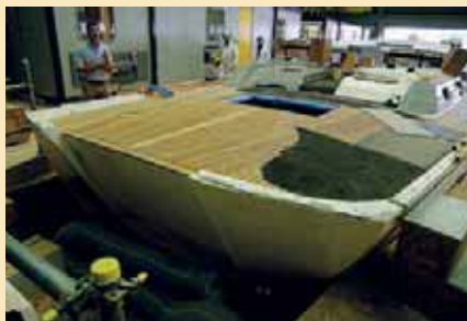
«Любой каприз за ваши деньги»: у только что выклеенного «Oyster 82» отрезали транец и «надставили» корму отсеком для подводного снаряжения
