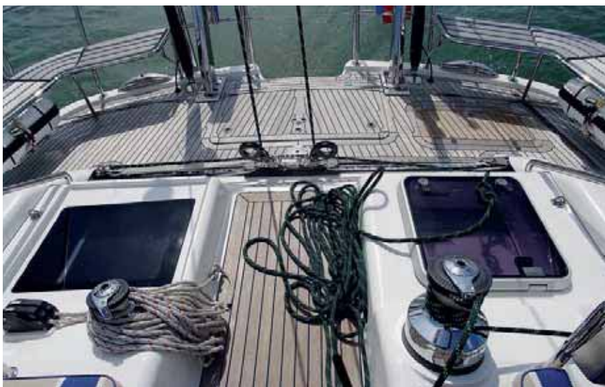
На кормовой палубе, как обычно, расположен отдельный выход из каюты хозяина (слева). Погон гика-шкота не мешает ни экипажу, ни гостям.
