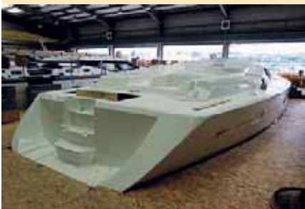
«Любой каприз за ваши деньги»: у только что выклеенного «Oyster 82» отрезали транец и «надставили» корму отсеком для подводного снаряжения
