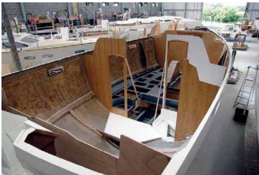
На британской верфи «Northshore Marine» бальсу используют исключительно в надводной части корпусов. Предварительно ее заклеивают в чехол из стеклоткани.
