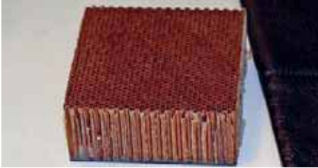
Кевларовые соты похожи на номексовы, но внешне отличаются более насыщенным цветом
