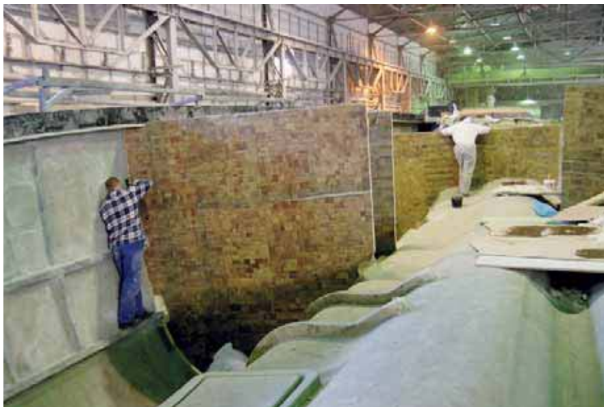
Бальса так легка, что рабочий (на заднем плане) в одиночку легко поднимает и перемещает довольно большую переборку из этого материала
