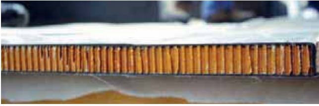
Номекс теперь стараются применять в относительно ненагруженных конструкциях, например, в переборках
