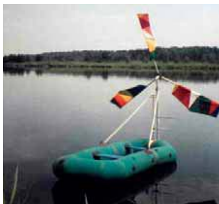
Рис. 5. Надувная лодка «Язь-3» с подвесным ветродвигателем
