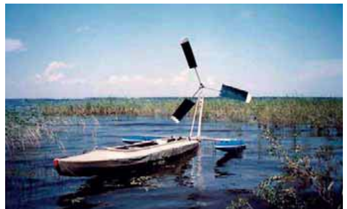
Рис. 3. Байдарка «Таймень-2» с ветродвигателем
