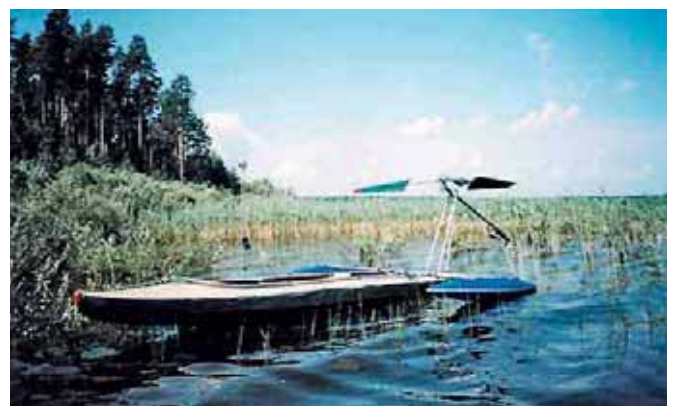
Рис. 4. Подвесной ветродвигатель в поднятом положении
