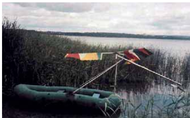
Рис. 6. Подвесной ветродвигатель на надувной лодке в поднятом положении
