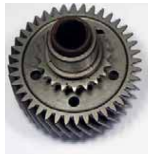
Шлицевое соединение торсионного вала разрушено коррозией из-за отсутствия сезонного технического обслуживания в течение нескольких лет. Сопряженные детали подлежат замене. Мотор – «Suzuki DF250».
