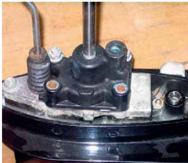
Подвесной мотор использовался в морской воде без регулярного технического обслуживания, в результате крепеж помпы «закис». Попытки клиента открутить корпус помпы самостоятельно закончились разрушением шпилек. Мотор – «Suzuki DF6».
