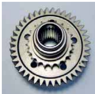
Новая оригинальная шестерня верхнего редуктора первой ступени. Мотор «Suzuki DF250».
