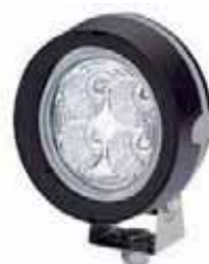
Новые светодиодные фары-искатели в необслуживаемом исполнении
