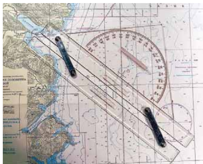
Рис. 2. Такая линейка-паралелограмм позволяет проводить параллельные линии на любом расстоянии друг от друга; для определения курса можно с равным успехом использовать как транспортир, так и нанесенную на свободное поле карты «компасную картушку»
