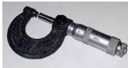
**Рис. 2.** Проконтролировать сечение «ложкообразных» лопастей можно только при помощи микрометра
