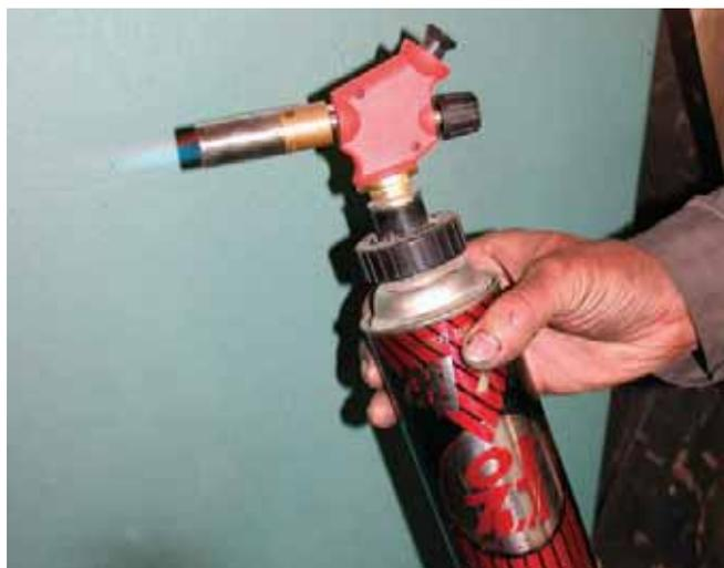
**Рис. 5.** Компактная, разжигающаяся «одним щелчком» газовая горелка может пригодиться при рихтовке
