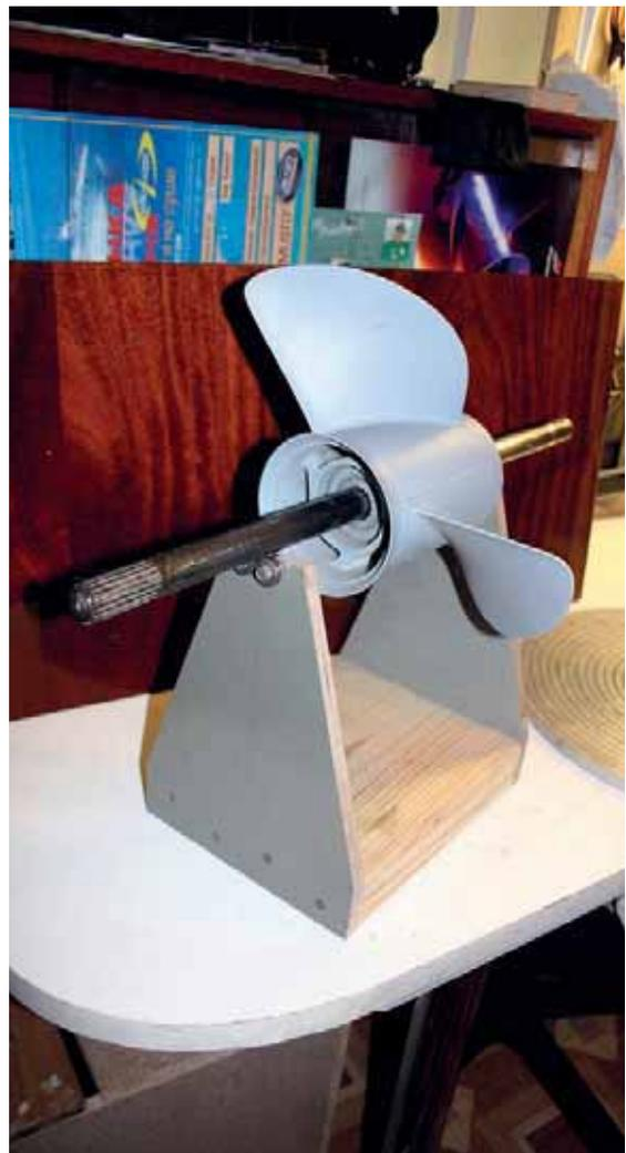
Рис. 11. При помощи такого станочка можно проверить статическую балансировку винта. Главное, чтобы вал вращался как можно свободнее — в данном случае он просто лежит на упорах из подшипников
