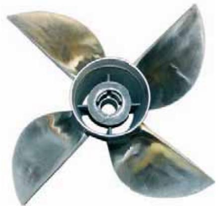
Рис. 8. Желательно, чтобы подрезанные выходные кромки располагались по диаметральным линиям винта
