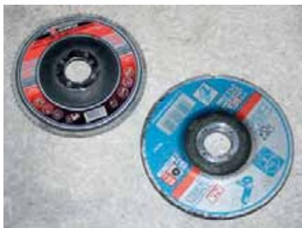
**Рис. 1.** Разнообразные шлифовальные круги, в том числе лепестковые (слева) значительно ускоряют процесс обработки
