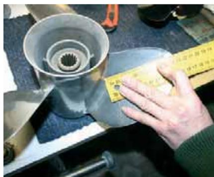
Рис. 7 Вначале по предварительной разметке подрезаем выходную кромку.
