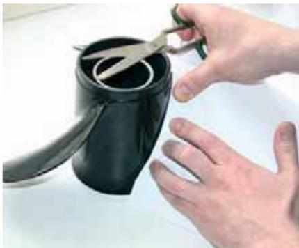
Рис. 6. Скопировать контур обработанной лопасти удобнее всего при помощи «бумажного слепка»
