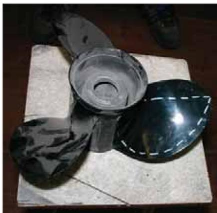
Рис. 9. При подрезке входных кромок более-менее повторяем существующий контур
