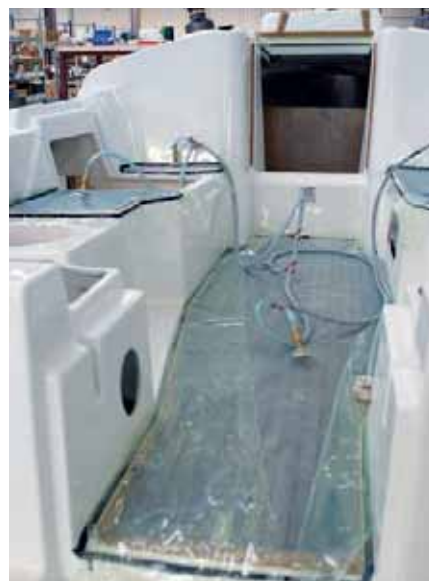
Вакуумные процессы с охотой применяют при формировании секций сравнительно плоских палуб – при этом нагрузки на матрицу гораздо меньше, чем при формировании секций корпусов
