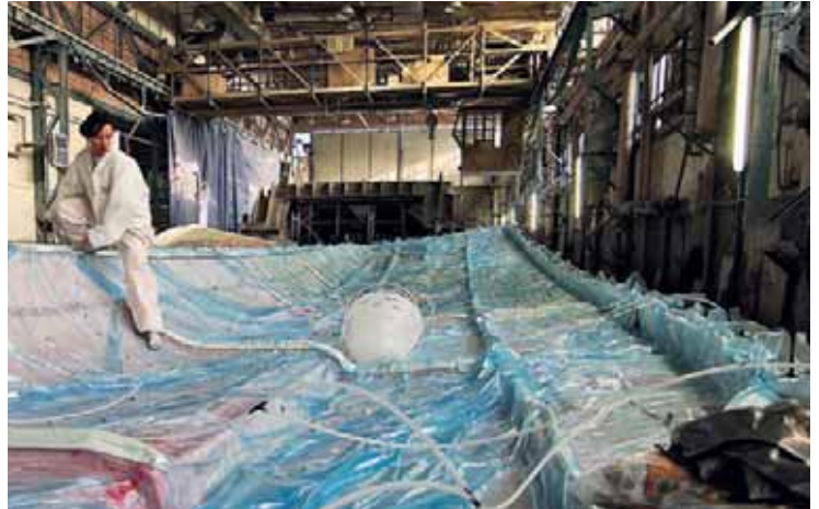
При производстве секций корпусов передовые верфи стараются использовать инфузионные и инъекционные технологии
