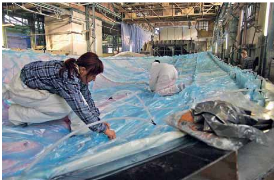
Вакуумные процессы с охотой применяют при формировании секций сравнительно плоских палуб – при этом нагрузки на матрицу гораздо меньше, чем при формировании секций корпусов
