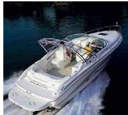
Пример «южной» компоновки относительно большого катера. Места в достатке, но доминирует открытый хорошо оборудованный кокпит с выходом на транцевую платформу. Носовая каюта выполняет вспомогательную роль.
