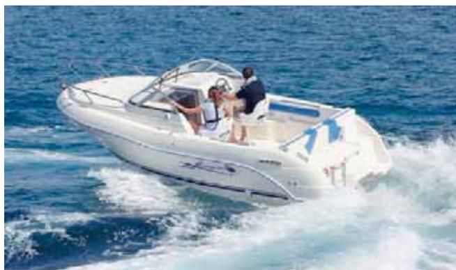
Каютный комфорт можно обеспечить и на относительно небольших катерах и моторных лодках 5–6 м длиной, но только либо оборудованием тесноватой рубки-убежища в носу («Cuddy Cabin»), либо смещением более просторной рубки-салона в более широкую кормовую часть корпуса. У каждого варианта свои преимущества.
