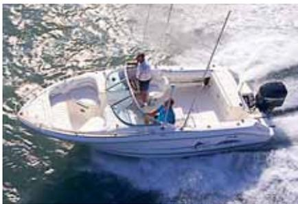
Вариация на тему двухконсольной компоновки – лодки типа «боурайдер». Носовой кокпит выполнен изолированным от кормового, проход в него закрыт дверцей в ветровом стекле. Часто применяется для пляжных мотолодок.
