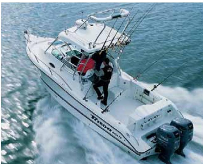
Сугубо рыболовный катер с компоновкой «walkaround» и небольшой спальной каютой дополнен жесткой крышей, придающей катеру черты «хардтопа». На ней удобно разместить троллинговое оборудование, закрепить тент, но габаритная высота резко возрастает.
