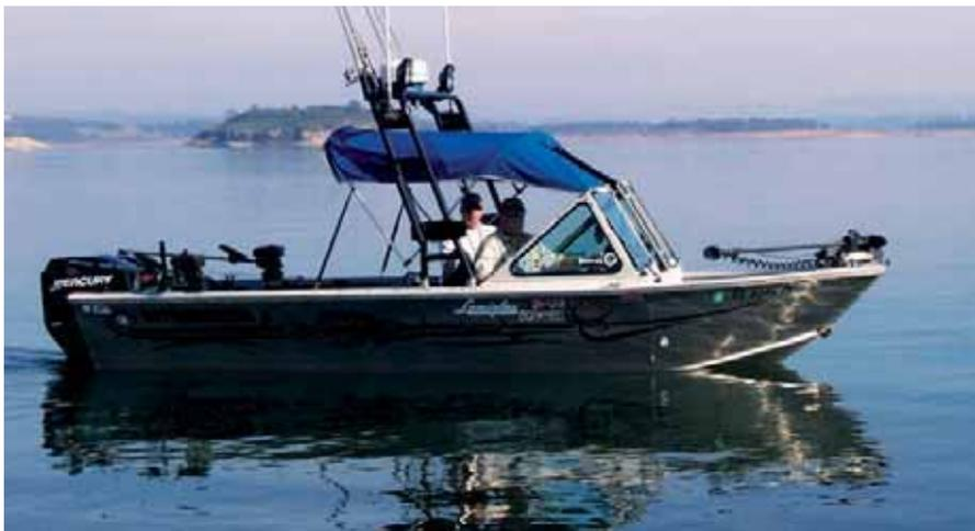
Популярная у нас типичная компоновка «кабриолет» с носовой посадкой водителя. Площадь кокпита используется эффективно, можно поставить тент, устроить спальные места. Но центровка лодки при этом зачастую получается излишне носовой, на волне водитель испытывает сильные перегрузки. Хорошо подходит для речных мотолодок.
