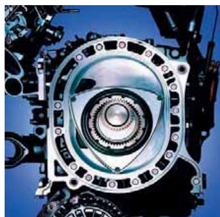
Разрез двигателя «Renesis»
