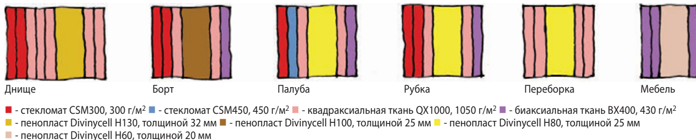
Рис. 6. Схема армирования конструкций катамарана «J60»
