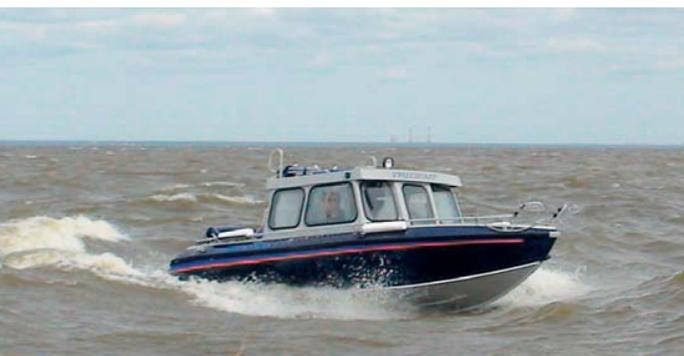
Условия во время испытаний катера «Trident 620 Cab»: нагрузка — 4 чел. плюс 50 л топлива, ПМ — четырехтактный «Suzuki DF175», ГВ — алюминиевый трехлопастной диаметром 14 3/4 и шагом 23 дюйма, скорость ветра — 8–14 м/с, высота волны — 0.8–1.5 м, темп. воздуха — 13°C, темп. воды — 9°, место испытаний — южное побережье Финского залива, г. Ломоносов
