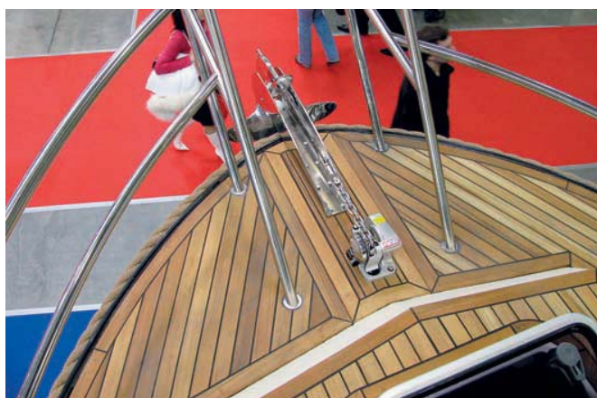
Проход через нос огорожен жесткой релинговой конструкцией
