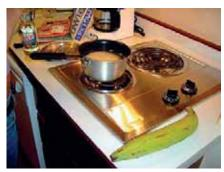
Электрические плиты хороши лишь на стоянке в марине, оборудованной береговым электропитанием. Касается это и самых компактных моделей мощностью «всего лишь» 2–3 кВт. Правда, по сравнению с «топливным» камбузным оборудованием такая техника отличается наиболее широким набором сервисных функций — в частности, допускает возможность программирования.
