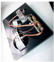
Как правило, приемные штуцеры импортных лодочных плит позволяют без проблем подсоединить стандартный шланг отечественного газового редуктора. Для большей надежности стоит закрепить его винтовым хомутом. Небольшие переделки могут понадобиться лишь в том случае, когда плита оборудована несъемным шлангом с резьбовым штуцером на конце — придется либо резать шланг, либо подбирать переходник.
