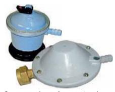
Быстросъемный газовый редуктор (слева) слишком капризен — болтается на клапане баллона и нередко «травит». Редуктор, крепящийся на резьбовом вентиле накидной гайкой (справа), значительно надежнее. Для его использования необходимо приобрести баллон соответствующего типа или же на имеющемся заменить клапан КБ-2 на вентиль ВБ-2. Делать это следует только в специализированной мастерской — например, при газозаправочном пункте.
