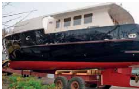
Длина яхты – 16,8 м, по КВЛ – 15,8 м, ширина – 4,8 м, полное водоизмещение – 28,9 т, осадка – около 1,5 м, надводный борт в носу – 2,15 м
