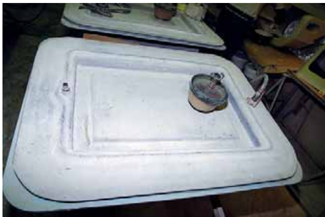
Для подачи высоковязкой особо прочной смолы емкости с ней располагают прямо над формуемой деталью на коротких жестких трубках (верфь «Amel»)
