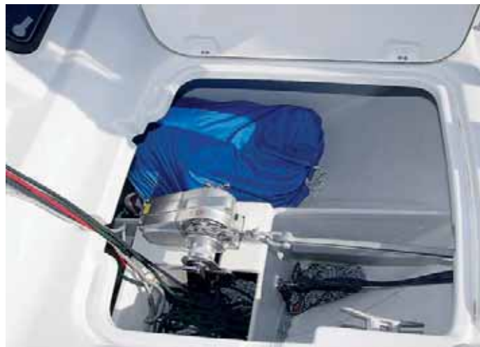
Носовой рундук: якорная лебедка, запасные паруса и концы убраны в одно место
