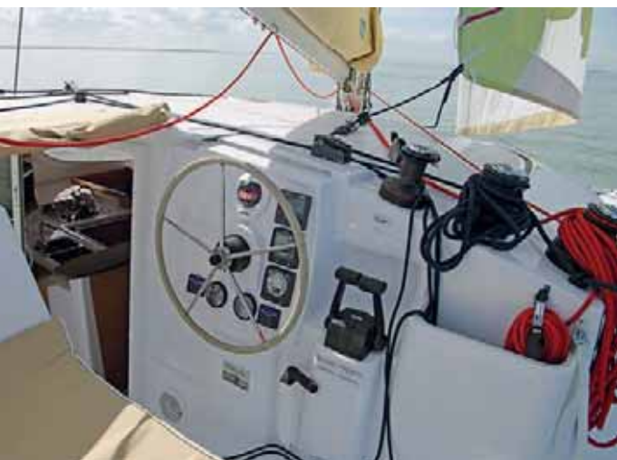
Место рулевого: отсюда можно выполнять все действия по управлению яхтой
