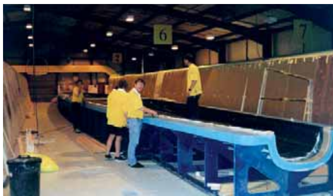
Формовка корпусов. В торце цеха виден макет сечения суперката. Справа – в цехе корпус «Ивана 30»
