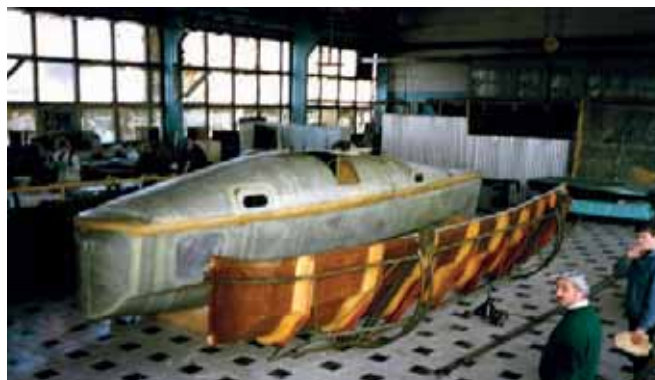
Формовка корпусов. В торце цеха виден макет сечения суперката. Справа – в цехе корпус «Ивана 30»
