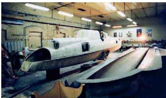
«Иван-32» в цехе. Слева – матрица и корпус, справа – контрольная сборка судна
