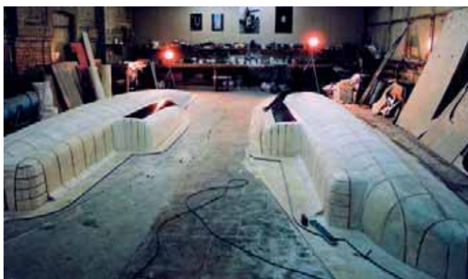
Болваны готовы к нанесению гелькоута и разделительного слоя (слева), болваны со снятыми матрицами половинок корпуса (справа)
