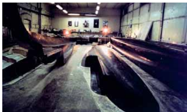
Болваны готовы к нанесению гелькоута и разделительного слоя (слева), болваны со снятыми матрицами половинок корпуса (справа)
