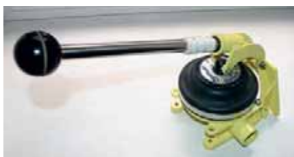
«Профессиональная» помпа марки «Whale», сертифицированная для применения на спасательных судах, имеет полностью алюминиевый корпус. Не используйте для ее установки бронзовый, латунный или медный крепеж — получившаяся электрохимическая «пара» вызовет интенсивную коррозию.
