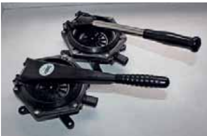
Съемная рукоятка удобнее, когда обитаемое пространство в месте установки помпы ограничено. Единственно, при энергичной работе она иногда выскакивает из гнезда, а кроме того, имеет свойство теряться.
