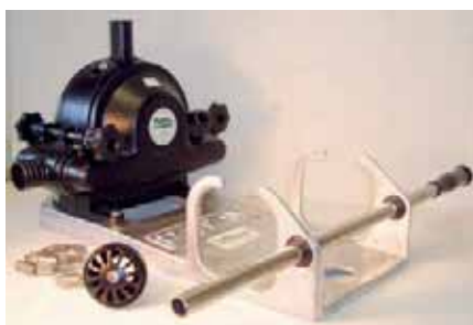
«Профессиональная» помпа марки «Whale», сертифицированная для применения на спасательных судах, имеет полностью алюминиевый корпус. Не используйте для ее установки бронзовый, латунный или медный крепеж — получившаяся электрохимическая «пара» вызовет интенсивную коррозию.
