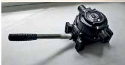
Двухкамерная помпа отличается высокой производительностью («рабочим» является ход рукоятки в любую сторону), но требует значительных физических усилий
