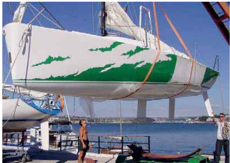
ски пластиковых судов и дала четкие рекомендации по соблюдению температурного и временного графика. По технологии после шпатлевки на корпус должны быть нанесены двухкомпонентный эпоксидный грунт, затем грунт под покраску и далее двухкомпонентная полиуретановая эмаль.
