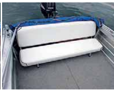
6. Кормовое сиденье опирается наконечниками спинки на пару пазов планширя и на пару ножек и снимается в считанные секунды
