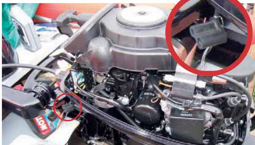
Доступ к фильтру прост, однако, чтобы его отвернуть, необходим особый ключ. Специальный резиновый «колпачок» (помечен красным кружком) хорошо защищает топливный коннектор в тех случаях, когда на него не надет коннектор бензинового шланга.
