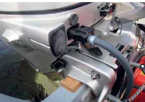
Мотор поднят на 12 мм. Этого достаточно для того, чтобы он «встал» на транец нормально. Расстояние от киля до антикавитационной плиты составило в этом случае 8 мм.
