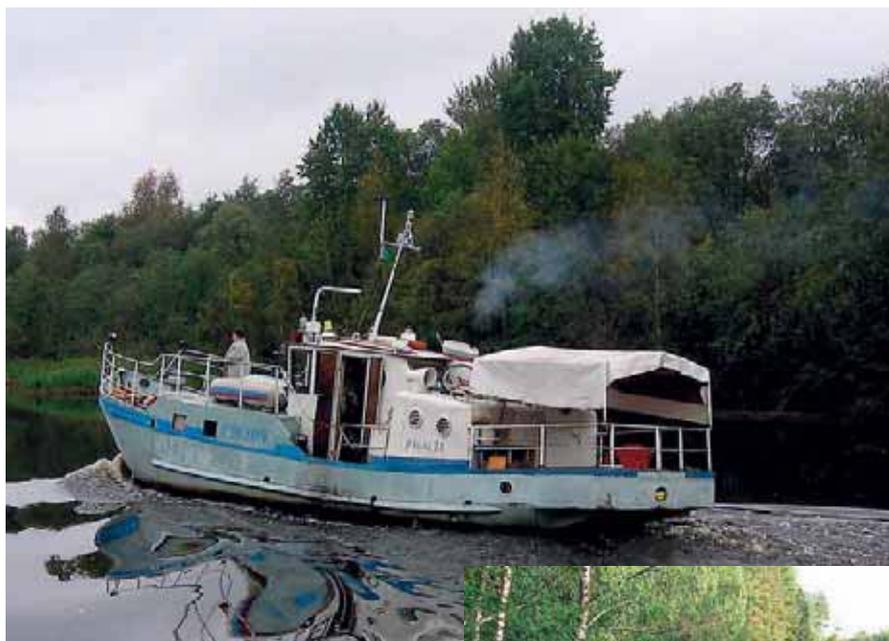
Водоизмещающий катер «Светоч» (создан на базе малого сепеподъемника новолодожской постройки)
