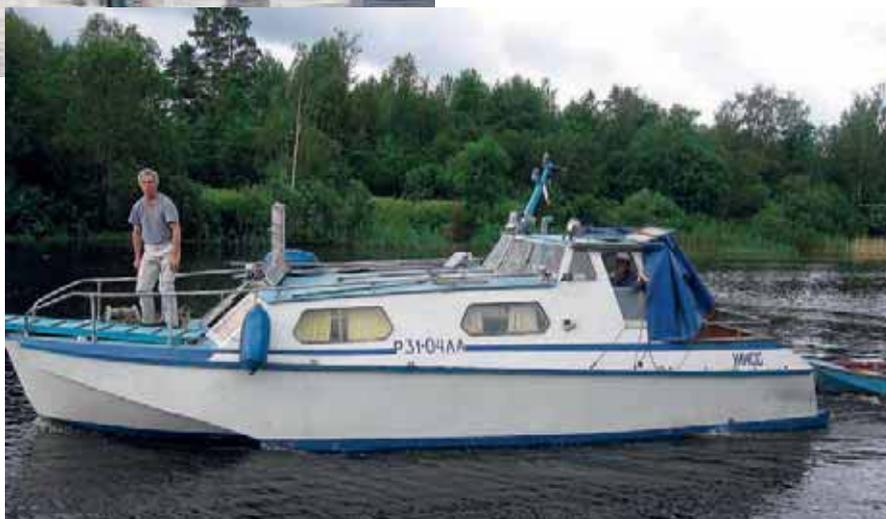
Водоизмещающий катер «Улисс» (корпус бывшего глиссирующего тримарана при переделке был удлиннен)
