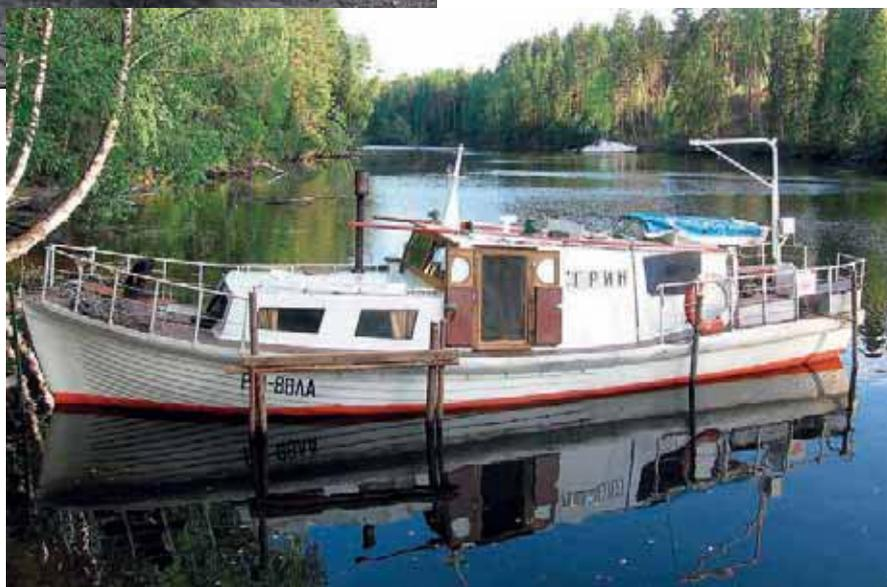
Водоизмещающий катер «Грин» (создан на базе спасательной шлюпки, выполненной из бакфанерных досок; при переоборудовании надстроена транцевая корма)
