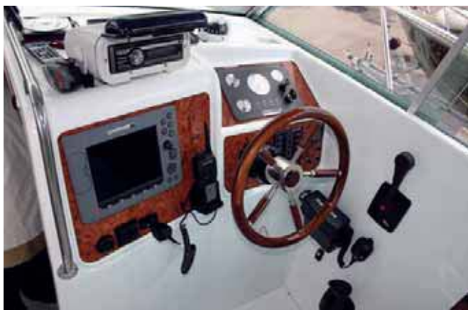
Встраиваемая «навигация» обычно используется на больших катерах класса моторных яхт...
