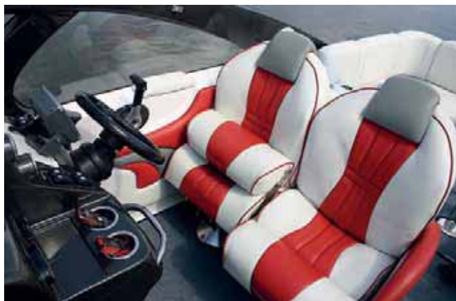
Для того, чтобы временно устроиться повыше (например, при движении в переходном режиме), удобна откидывающаяся вверх подушка сиденья
