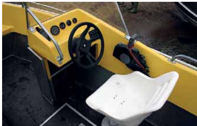
Ковшеобразное пластиковое кресло желательно снабдить дренажными отверстиями, чтобы в нем не скапливалась дождевая вода
