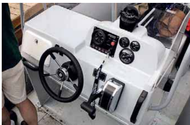
Расположение штурвала по центру — довольно редкое решение, применяемое в основном на «профессиональных» лодках
