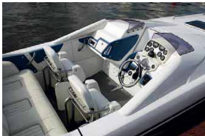
Сиденья на этой скоростной лодке оказались не очень удобными, несмотря на замысловатый алгоритм раскладки — боковая поддержка явно недостаточна, особенно при управлении стоя
