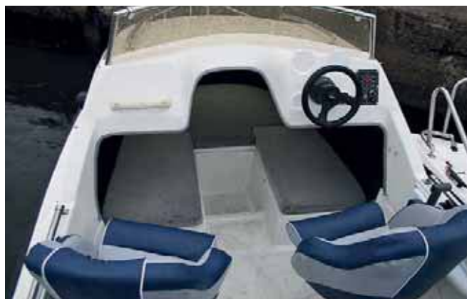
На лодках с полурубкой-хардтопом может применяться как низкая (слева), так и высокая (справа) посадка водителя. В первом случае водитель всегда защищен от брызг и осадков, во втором — гораздо лучше обзор.
