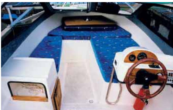
На лодках с полурубкой-хардтопом может применяться как низкая (слева), так и высокая (справа) посадка водителя. В первом случае водитель всегда защищен от брызг и осадков, во втором — гораздо лучше обзор.
