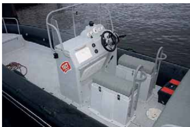
Компактную посадку «по-мотоциклетному» часто используют на судах профессионального назначения
