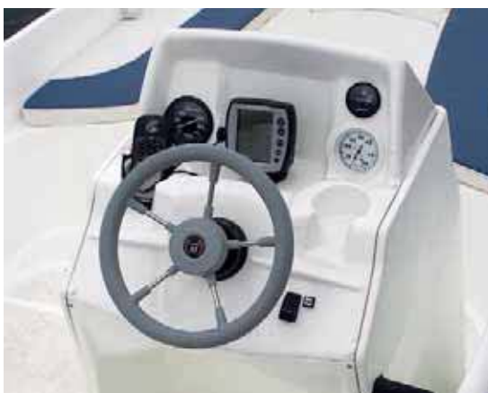
Грамотно спроектированную и рассчитанную на установку навигационных приборов рулевую консоль можно увидеть и на лодке менее 4 м длиной
