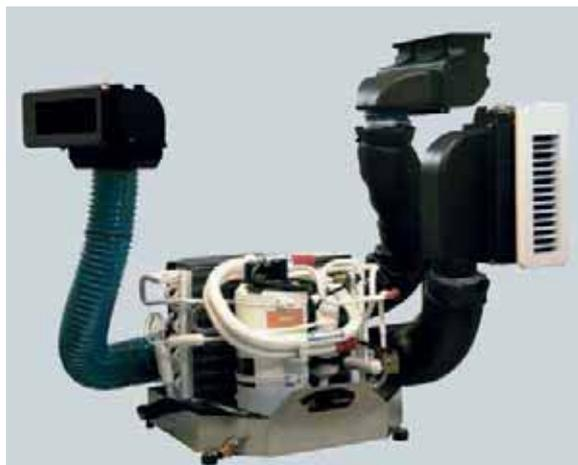
Кондиционер системы «Blue Cool Select» для обслуживания двух кают. Показан с подсоединенными штатными воздухопроводами (слева — неизолированный, с решеткой рециркуляционного воздуха, справа — два теплоизолированных воздухопровода с вентиляторными блоками). Фирма «Webasto AG», Германия.
