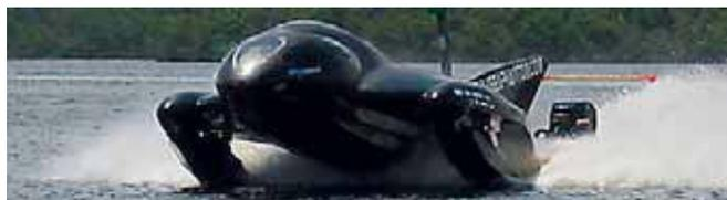
«Морской фантом» Дэвида Бормана - воплощение мечты летчика о морских просторах. Опытный образец с подвесным мотором доказал реальность идеи, на очереди - покорение барьера в 150 уз с газотурбинным двигателем
