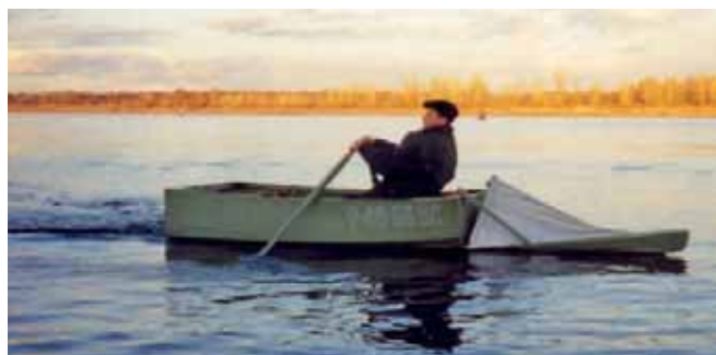
Рис.3. Сходня удлиняет ватерлинию лодки. Тент позволяет снизить сопротивление
