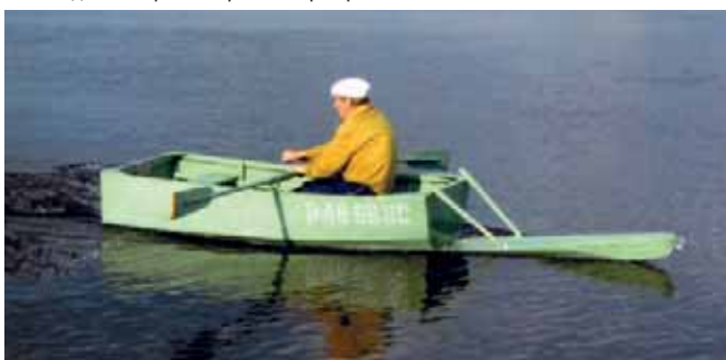
Рис.2. Сходня, прикрепленная к носу судна в походном положении
