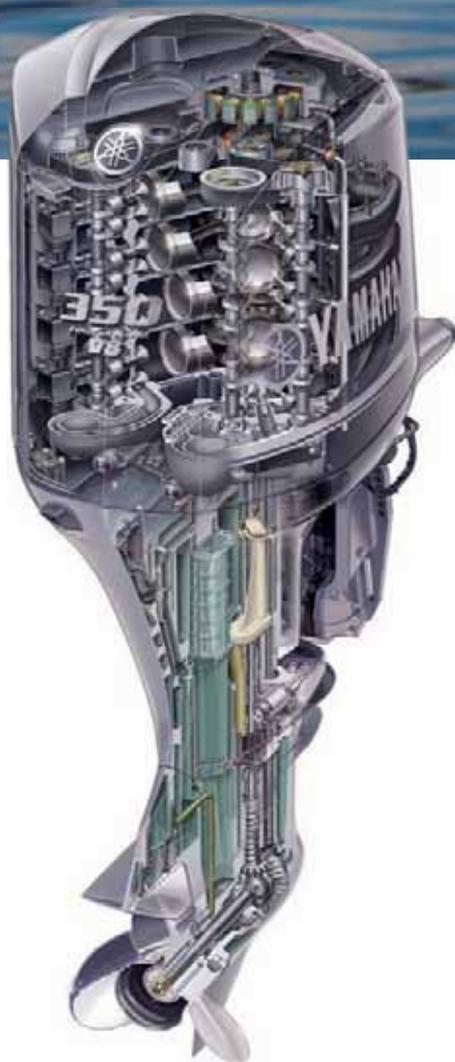
На каждый цилиндр работают по четыре клапана увеличенного диаметра.
