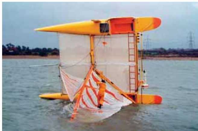
На катамаране «Orion» испытывается система самоспряжения яхты
