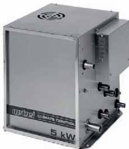
Центральный агрегат климат-контроля «Vetus Den Ouden», модель «CLIMA05». Холодопроизводительность — (17000 БТЕ/ч, теплопроизводительность (регулируемая) — 2,3–5 кВт. Расход дизельного топлива — 0,27–0,62 л/ч. Агрегат рассчитан на внутренний объем помещений до 21 м 3 . Габаритные размеры — 410×400×450 мм.
