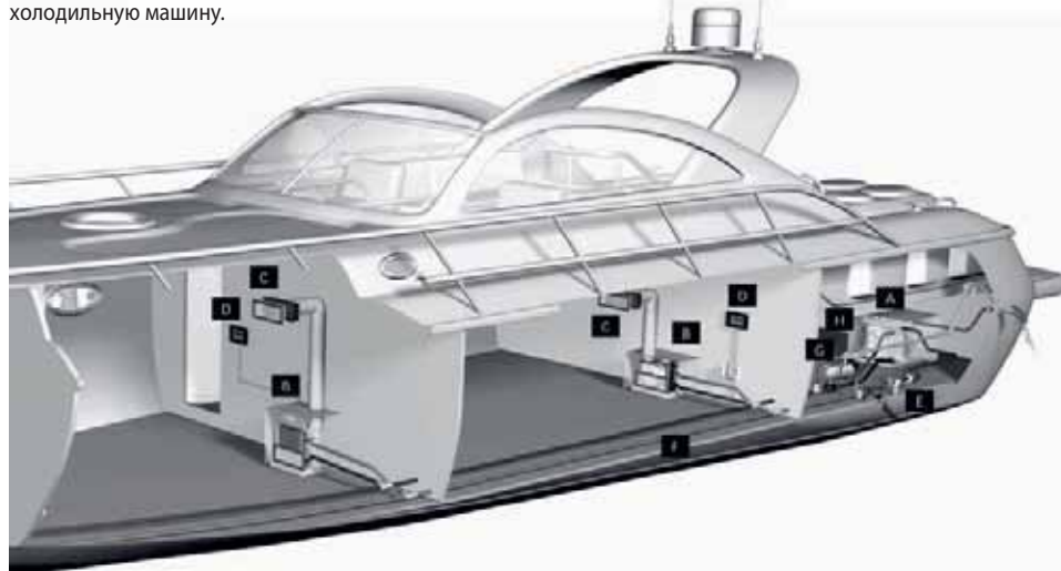
СКВ «Blue Comfort Premium» фирмы «Webasto»: А – чиллер в моторном отсеке; В – фен-койлы в обслуживаемых каютах; С – подача в каюту охлажденного или подогретого в фен-койле воздуха; D – каютная панель управления индивидуальным микроклиматом; Е – контур охлаждающей забортной воды чиллера; F – циркуляционные трубопроводы охлажденной или подогретой отопителем воды; G – дизельный отопитель; H – топливная система, - безопасная и не загрязняющая трюм.
