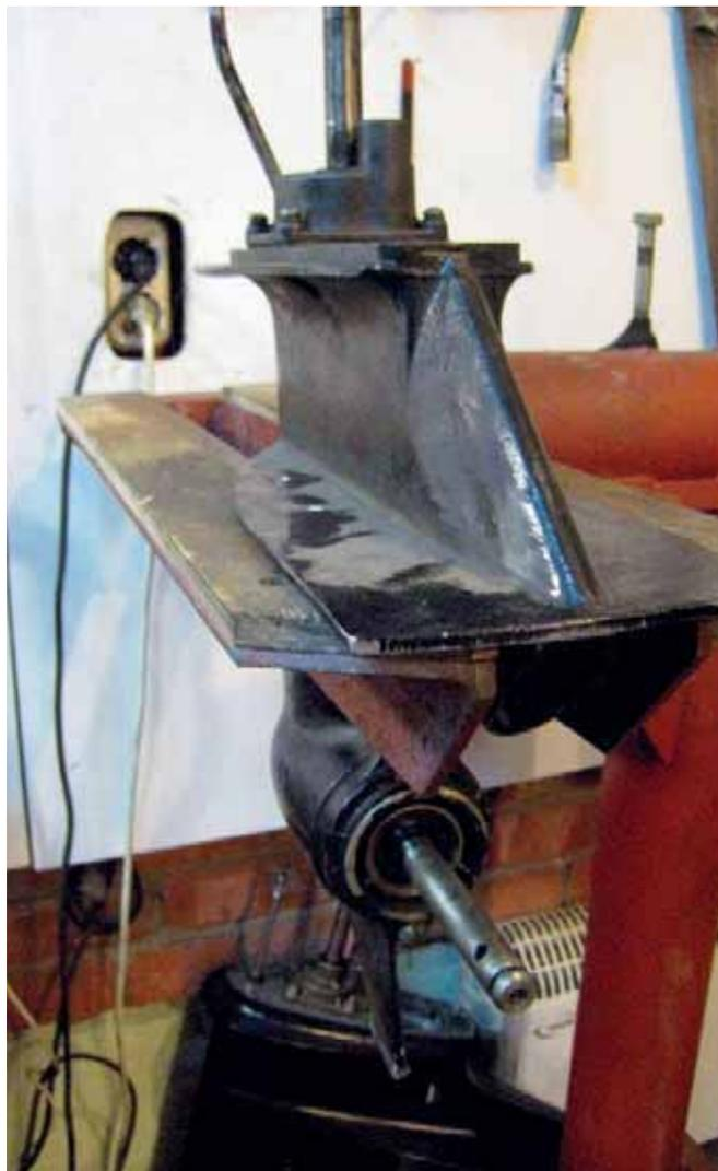
гайки, шайб и деревянного (или металлического) бруска с отверстием. Мы использовали металлический брусок с соответствующим отверстием. Полностью вынимать стакан не надо, достаточно «приподнять» его на 10 мм, и шестерня вертикального вала «провалится» в корпус редуктора. Далее надо вынуть шестерню, которая находится в глубине корпуса (за шестерней вертикального вала).
