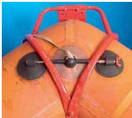
Крепление самодельного транца к лодке через дополнительные резиновые шайбы
