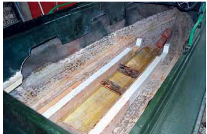
Днищевые стрингеры образованы П-образной обформовкой пенопластовых балок, расположенных вдоль реданов
