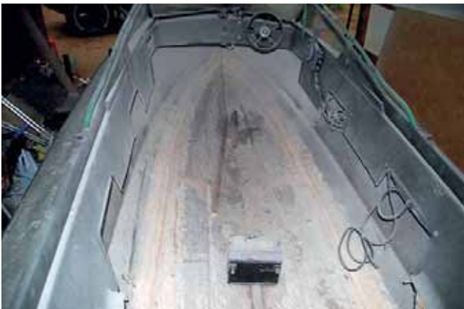
Вторая стадия работ – усиление днища новым набором. Старые пайолы сняты, намокший пенопласт удален, пластик днища зачищен.
