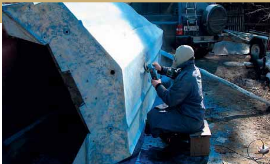
Зачистка старых покрытий – самая грязная часть работ по корпусу. Но делать ее необходимо, поскольку надлежащее качество декоративного покрытия – залог долгой службы пластика
