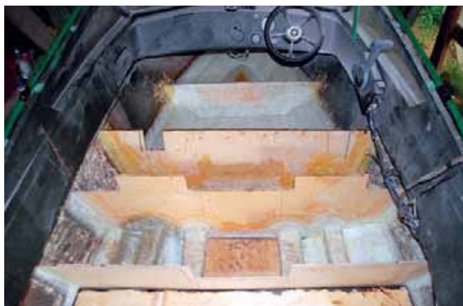
Стрингеры опираются на фанерные переборки, образуя вместе с пайолами мощный набор
