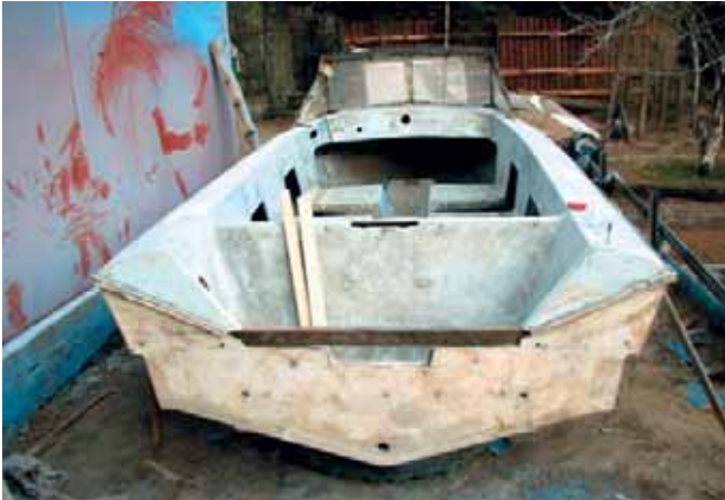
При неправильном хранении корпуса сильнее всего страдают деревянные заформовки. Конструкции транца необходимо обновить и усилить под более мощный мотор.
