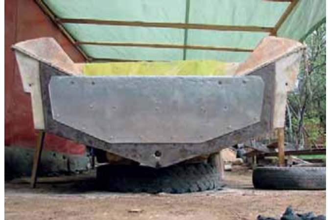
При неправильном хранении корпуса сильнее всего страдают деревянные заформовки. Конструкции транца необходимо обновить и усилить под более мощный мотор.
