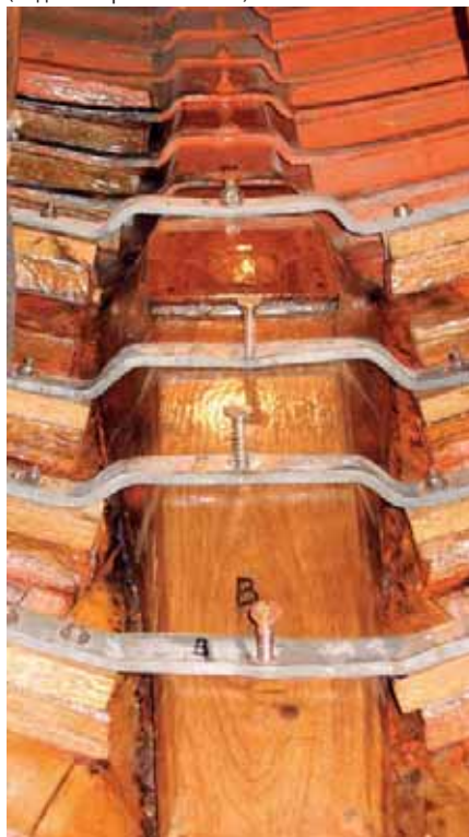
Отремонтированный контртимберс (вид со стороны кокпита)
