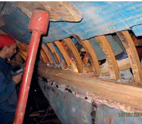
Укорачиваем длину шпилек, держащих флоры
