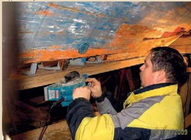
Подгонка верхней части килевой балки
