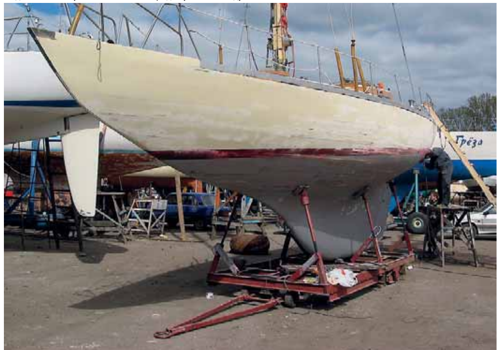
Лодка после забухания обшивки перед спуском на воду
