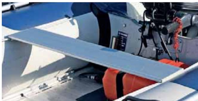
кой. Увы, при обилии прочих опций на пайоле не обнаружилось ни единого рыма или обушка, позволяющего надежно раскрепить груз в строго определенных местах, разместив его наиболее выгодным с точки зрения центровки образом.
