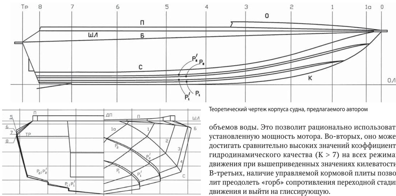
Теоретический чертеж корпуса судна, предлагаемого автором
