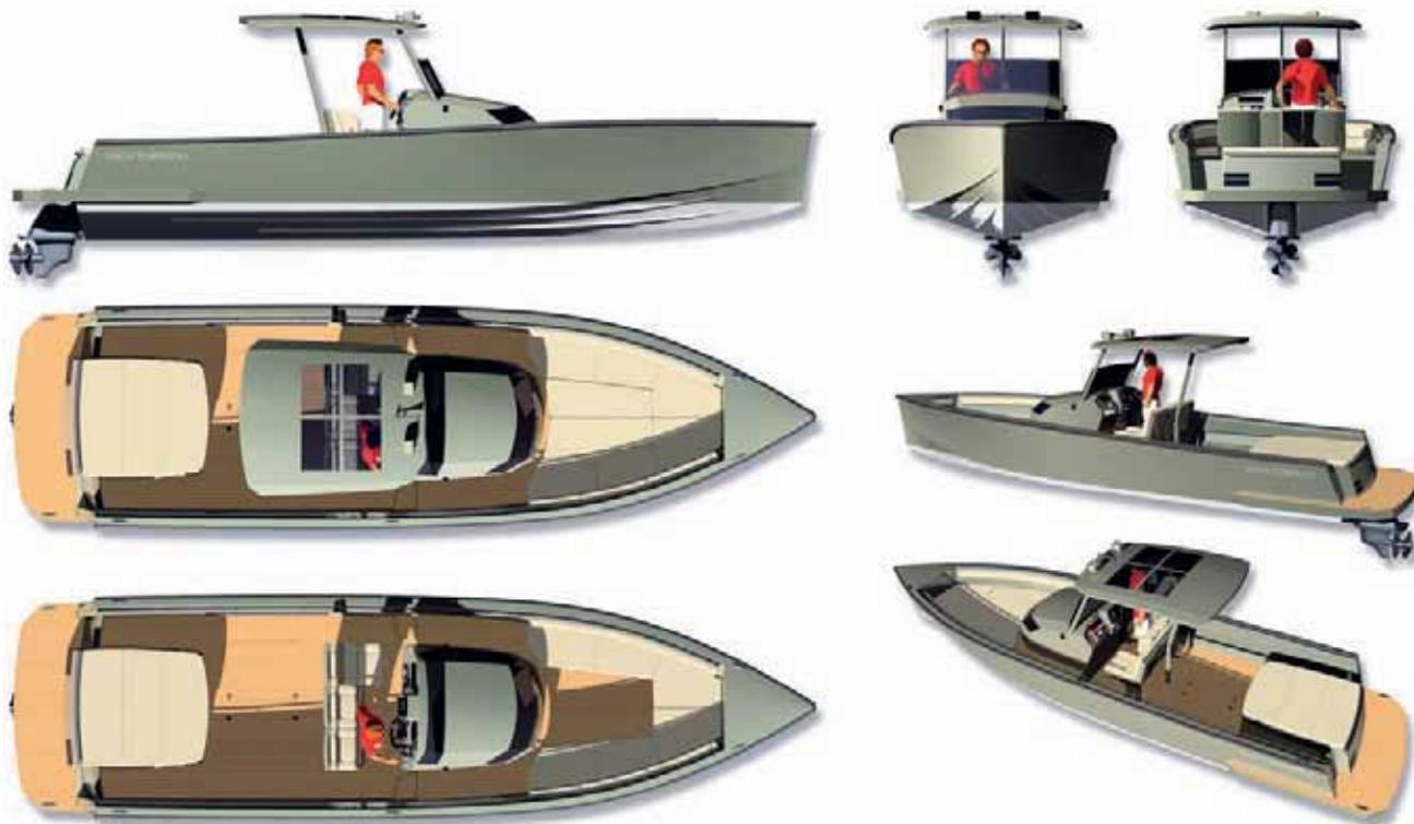
**Рис.9. Катер «Torpedo28» длиной 8.5 м – пример стиля «милитари» с центральной консолью**
