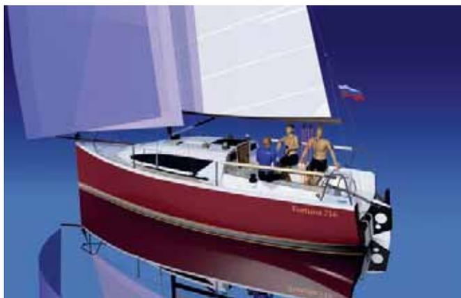
**Рис.10. Парусная трейлерная яхта-швертбот «F716» длиной 7.16 м**
