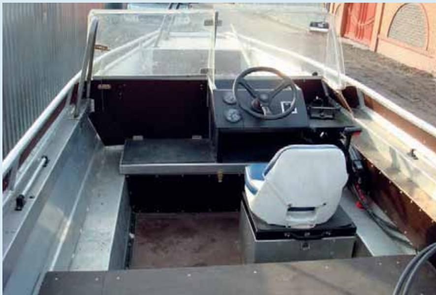
Под креслом водителя – рундуке, в котором находятся аккумулятор, запасной винт и инструмент
