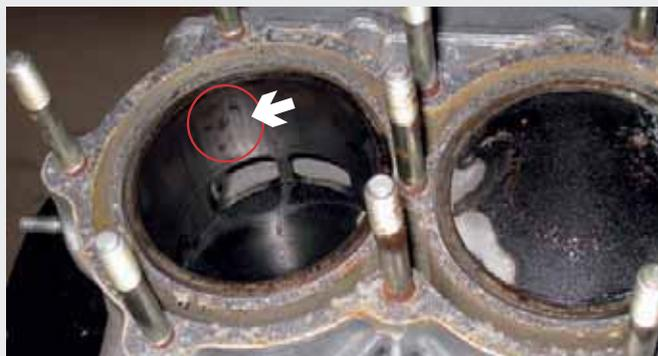
На стенках необработанного консервантом цилиндра (слева) хорошо видны очаги коррозии, на шпильках – ржавчина, появление которой спровоцировало ослабление поджатия головки.
