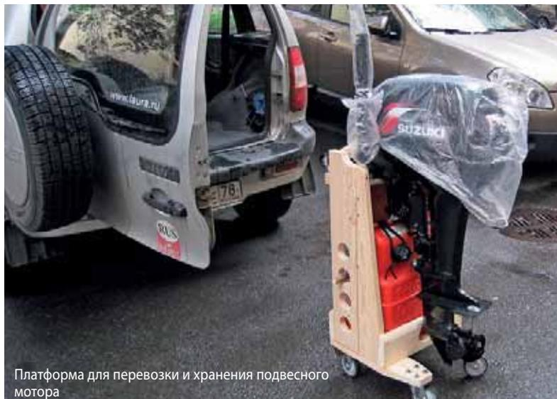
Платформа для перевозки и хранения подвесного мотора
